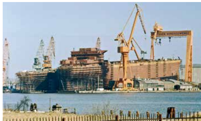
Da brummt der Schiffbau noch: Auf den Helgen der Nordseewerke liegen der Gastanker „Galpara“ (links, London) und der Massengutfrachter „Suorva“ (Stockholm). Foto: Wolfgang Fricke / Wikimedia Commons, 1976
